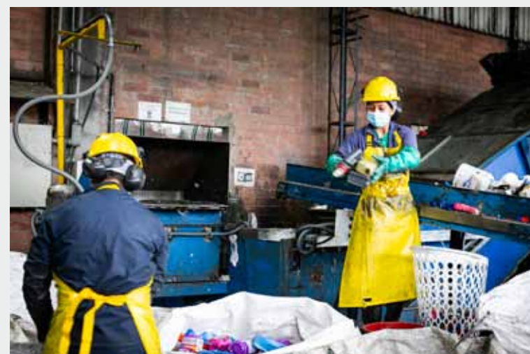
EL PROCESO se inicia con la selección, separación y clasificación del material según el tipo de polímero.
